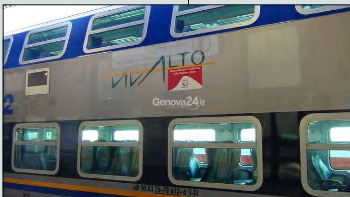
Uno dei 15 treni "Vivalto" a due piani entrati in servizio tra 2009 e 2015 sulla rete ferroviaria ligure, con spese a carico della Regione sia di Trenitalia. Dotati di 600 posti a sedere, sono utilizzati per il servizio pendolari. Per la loro messa in funzione è stato necessario procedere preliminarmente alla revisione delle sagome di alcune gallerie.
